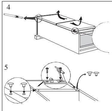
6. Переверните оборудование двери в противоположное положение. Вставьте новую заглушку в отверстие нижней двери.
